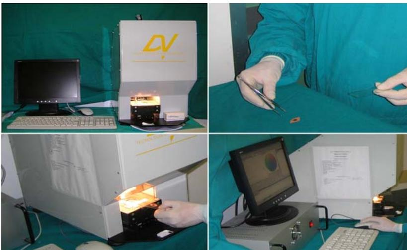
*Fig. 4: Prototipo Off Line. Processo di acquisizione ex vivo dopo exeresi chirurgica. In alto a sinistra: setup dello strumento; In alto a destra: posizionamento del pezzo operatorio su apposito vetrino; In basso a sinistra: alloggiamento del preparato sul supporto mobile; In basso a destra: avvio del processo di acquisizione, visualizzazione ed analisi della lesione.*
